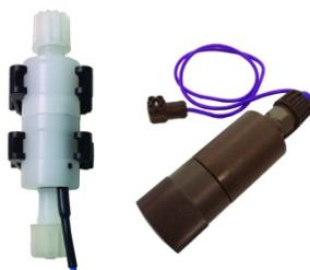
Датчик выходного потока для насосов-дозаторов 1-20 л/ч (PVDF) и 30-80 л/ч (ПВХ). Подсоединяются к головке насоса. Магнитный контакт (геркон) установлен в оболочку из Тефлона. Служат для анализа выхода дозируемого реагента из головки насоса. Совместимость с моделями насосов: BT-MA/M, BT-MF, DLX(B)-MF/M
