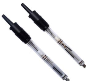
Резьбовые датчики уровня PH и RX (ОВП) с кабелем. Корпус датчиков выполнен из стекла. Мах. температура - до 100°C. Мах. давление до 7бар. Диапазоны измерений: 0÷14 pH; ± 1.000 mV.
