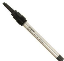
Датчик для измерения растворенного кислорода. Корпус датчика выполнен из нержавеющей стали, мембрана с платиновым/серебряным электродами. Диапазон измерений: 0-20 ppm. MAX. рабочая температура - 60° C. Диапазон рабочего давления в системе: 0-4 бар. Диаметр корпуса: 12 мм. Резьба на корпусе PG13.5. Соединительный кабель - 5 м.
