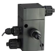
Датчик выходного потока для определения мутности, работает по методу NTU с помощью фотодиода, который определяет количество отраженного света. Диапазон измерений: 0-1000 NTU. Исполнение: корпус датчика изготовлен из ПВХ. Для корректной работы датчика, необходим постоянный поток в интервале 1-15 л/ч. Max. противодействие в системе - 1 бар. Max. температура: 60°С. Подсоединения: 1/2" на шланг 10x14.
