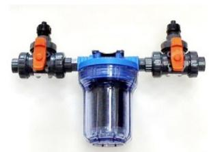
Проточный (OFF-LINE) CARB. комплект для обвязки датчика хлора SCLO 3 (HYCHLOR). Max. температура – до 45 °С. Max. противодействие в системе – до 5 бар. Предназначен для обвязки, калибровки нулевого значения остаточного хлора. Подсоединения: 1/2". В состав монтажного комплекта входит: 3-х ходовой кран ПВХ 1/2" – 2 шт., шланг ПВХ(ПЭ) 10x14 – 40 см, фильтр с картриджем из активированного угля; соединительный фитинг, кронштейн крепления на стену, саморезы.
