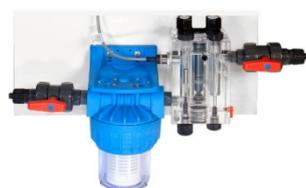
Проточный (OFF-LINE) держатель датчиков PH-RX-CL (FS) с монтажным комплектом. Max. температура – до 45 °С. Max. противодействие в системе – до 5 бар. Подсоединения: ниппель 1/2" на шланг 10x14. В состав монтажного комплекта входит: шланг ПВХ 10x14 - 10 м. п., кран ПВХ 3/8" – 2 шт., префильтр с картриджем 150 микрон; соединительный фитинг, кронштейн крепления на стену, саморезы, **без датчика потока.**
