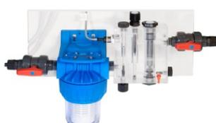
Проточный (OFF-LINE) держатель датчиков PH-CL с монтажным комплектом. Max. температура – до 45 °С. Max. противодействие в системе – до 5 бар. Подсоединения: ниппель 1/2" на шланг 10x14. В состав монтажного комплекта входит: шланг ПВХ 10x14 - 10 м. п., кран ПВХ 3/8" – 2 шт., префильтр с картриджем 150 микрон; соединительный фитинг, кронштейн крепления на стену, саморезы, **без датчика потока.**
