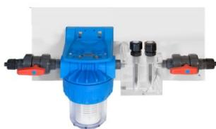
Проточный (OFF-LINE) держатель датчиков PH-RX с монтажным комплектом. Без датчика потока. Max. температура – до 45 °С. Max. противодействие в системе – до 5 бар. Подсоединения: ниппель 3/8" на шланг 10x14. В состав монтажного комплекта входит: шланг ПВХ 10x14 - 10 м. п., кран ПВХ 3/8" – 3 шт., префильтр с картриджем 150 микрон; соединительный фитинг, кронштейн крепления на стену, саморезы.
