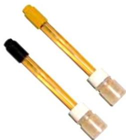
Датчики уровня PH и RX (ОВП). Корпус из эпоксидного пластика. Мах. давление - 6 бар. Мах. температура - до 60°C. Диапазоны измерений: 0÷14 pH; ± 1.000 mV. Без соединительного кабеля. Кабельный разъем: DIN 19262, SN6.
