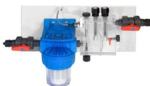
Проточный (OFF-LINE) держатель датчиков PH-RX с монтажным комплектом. Max. температура – до 45 °С. Max. противодействие в системе – до 5 бар. Подсоединения: ниппель 1/2" на шланг 10x14. В состав монтажного комплекта входит: шланг ПВХ 10x14 - 10 м. п., кран ПВХ 3/8" – 2 шт., префильтр с картриджем 150 микрон; соединительный фитинг, кронштейн крепления на стену, саморезы, **без датчика потока.**
