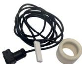
Реверсивный датчик уровня реагента с магнитным контактом (герконом) и пластиной крепления к клапану забора. Длина кабеля - 2 м. Штекер типа «Hirschmann» (G4W1F). Подходит для жидкостей с минимальным удельным весом: 0,8. Коммутация: max. 50 Вт (SPST); 200V DC /240V AC; max. коммутируемый ток 0.5A. Рабочая температура до 50 °C.
