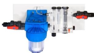
Проточный (OFF-LINE) держатель датчика SONDA CL с монтажным комплектом. Max. температура – до 45 °С. Max. противодействие в системе – до 5 бар. Подсоединения: ниппель 1/2" на шланг 10x14. В состав монтажного комплекта входит: шланг ПВХ 10x14 - 10 м. п., кран ПВХ 3/8" – 2 шт., префильтр с картриджем 150 микрон; соединительный фитинг, кронштейн крепления на стену, саморезы, **без датчика потока.**
