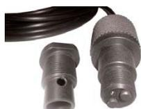
Датчики электропроводности (CD) с электродами из графита, с защитным колпачком. Подсоединения: 3/4". Диапазон измерений: 0-40.000 µS. Мах. давление - 5 бар. Соединительный кабель - 5 м.
