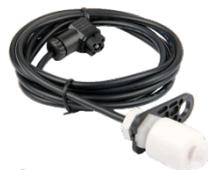
Датчик уровня погружной с кабелем 2 м. с возможностью регулировки по высоте. Исполнение: ПВХ-Viton и ПВХ-TFE/P (для насосов eONE). Предназначен для установки в емкости/канистры с химическими реагентами. Применение: для насосов до 20 л/ч (шланг 4x6); для насосов 30-140 л/ч (шланг 10x14).
